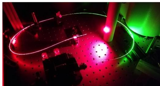
図1 ピコ秒スーパーコンティニューム光発生の様子。目に見えない1064 nmのレーザー光をPCFへと導入し、黄色~赤色の光を含む超広帯域光発生を実現した。
