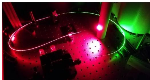
図 1 ピコ秒スーパーコンティニューム光発生の様子。目に見えない 1064 nm のレーザー光を PCF へと導入し、黄色～赤色の光を含む超広帯域光発生を実現した。
