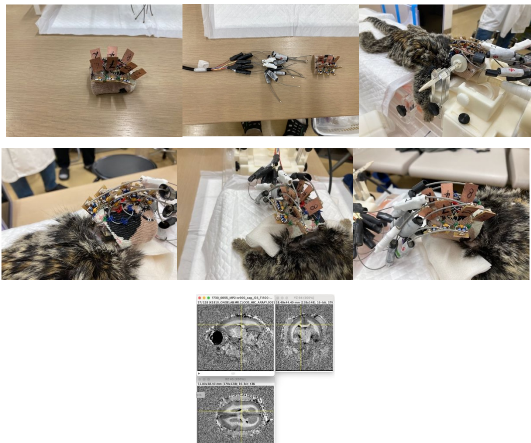
図4 伸縮性のある円筒形の布地に10ch分の高インピーダンスコイルを縫い付けたもの(上段左、中)とそれをマーモセットに頭部装着した様子(上段右、中段)、及び、このコイルで撮像したマーモセット頭部画像(下段)
