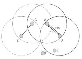
の動作は妥当である。しかし、D CのAck さえ受信できればこの問題は解決し、A BとC Dの同時通信により通信の空間利用効率が向上する。Ack 多重化技術は、A Bにフレーム送信中(電波はCにも届く)でも、D CへのAck を受信できるようにする技術である。CがAの電波を検知中でも、(i)DからCへのAck フレーム送信タイミングで、(ii)Cの受信電波強度が上昇すれば、DからAckが送信されたことが判定できる。各シンボルの受信電力が確率的に変動すると仮定すれば、1%の確率的有意差で検定すれば、99%の確率で正しくAckを検知できる。このAck多重化により、空間利用効率が大幅に向上し、CSMA/CAの通信効率が大幅に上がる。
