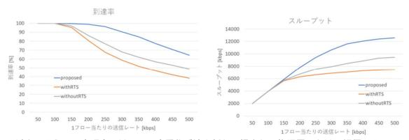
以上のように、本研究では、Ack 多重化手法を新たに提案し、物理層における評価によって、しきい値 T を 1 dB 以上 (実際には余裕をもって  $2\sim3$  dB に設定すると良い)に設定すれば、高精度に Ack の検出が可能となり、誤り確率も十分に低くなることを検証した。また、提案手法をネットワークシミュレータ Scenargie に実装した。シミュレーション評価を通じて、しきい値 T を 3 dB に設定した場合に、従来手法と比較して大きく性能向上できることを検証した。
