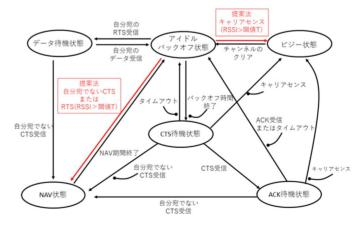
法で異なる点は自分宛でない RTS を受信したときの動作とキャリアセンスの動作が異なる。 CSMA/CA ではバックオフ、データ待機、CTS 待機、ACK 待機状態のいずれかであるときに自分宛でない RTS または CTS を受信したとき、NAV 状態へ遷移する。これに対して提案手法では、バックオフ状態にあるとき自分宛でない RTS を受信した送信ノードは、RSSI が閾値 T 以下であればビジー状態へ遷移せず、バックオフ状態を続行する.もし閾値 T 以上であれば、この後に送信されるデータフレームの RSSI も閾値 T 以上となり、RSSI による CTS または ACK の検知ができない可能性があるため、CSMA/CA と同様に NAV 状態へ遷移する。キャリアセンスでは RSSI が閾値 T 以上の場合、RSSI による CTS または ACK の検知ができない可能性があるため、ビジー状態へと
