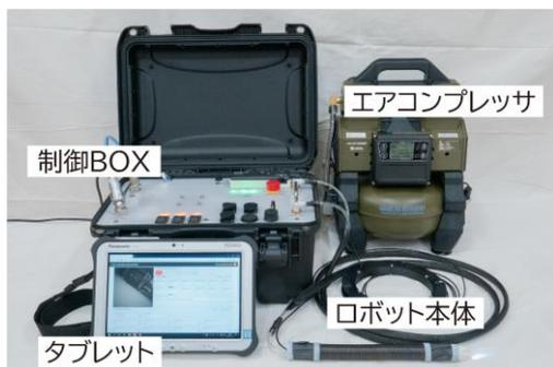
図 7 開発した配管内点検ロボットシステム
