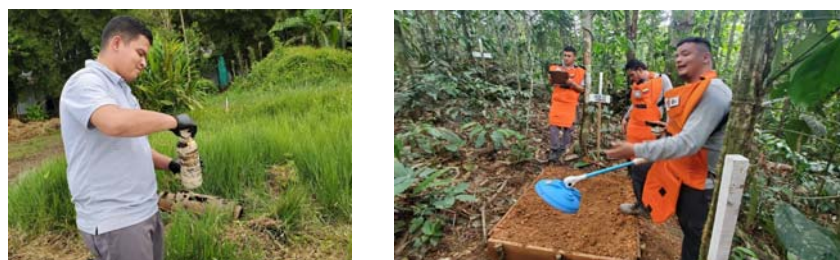
図4 CCCMと地雷原で実施したALIS試験
