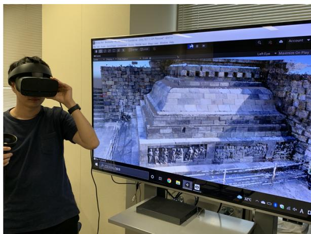
**図 8** 3次元計測点群を入力データとして用いたボロボドゥール寺院の VR システム
