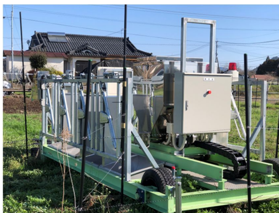
図 1. 放牧地に設置された個体識別遠隔自動給餌機。
