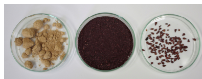
図 1. 北海道ワイン株式会社の自社技術により分別されたワイン醸造後の副産物 左：酵母澱（ナイヤガラ） 中央：醸造後のブドウ果皮（ツヴァイゲルト） 右：醸造後のブドウ種子（ツヴァイゲルト）
