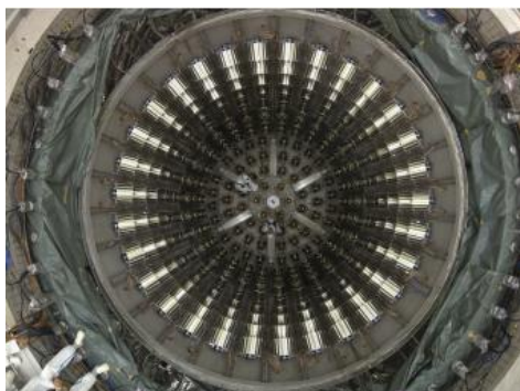
図4、PMT 設置後の Near 検出器の写真。
