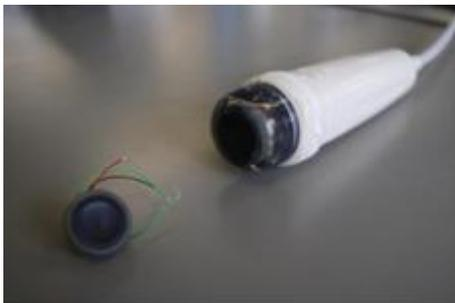
図2 試作振動子とそれを内蔵したメカニカルセクタプローブ
