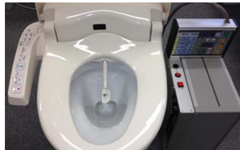
図9 便座内蔵型プロトシステムの外観
