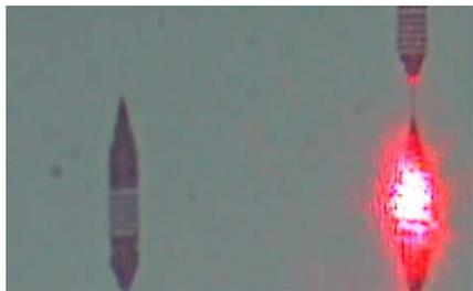
図11 LRSPP 伝送実験の光学顕微鏡像 出力カップラーよる外部への取り出しが観測できる
