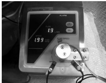
Fig4 血液ポンプの回転数周期変動器
