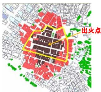
図1 ひがし茶屋街の延焼シミュレーション
