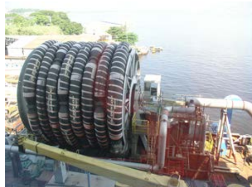
図3：FPSOからシャトルタンカーに輸送するためのフレキシブルチューブ
