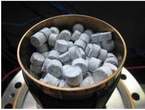
図2 ペレット化したEM材料を充填した反応器（ペレット直径7mm、容器直径は48mm）
