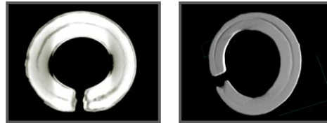
写真3,4 芯の内部に見られる空隙
