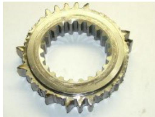
図 2 (a)SRIQ 歯車 破面全体図
