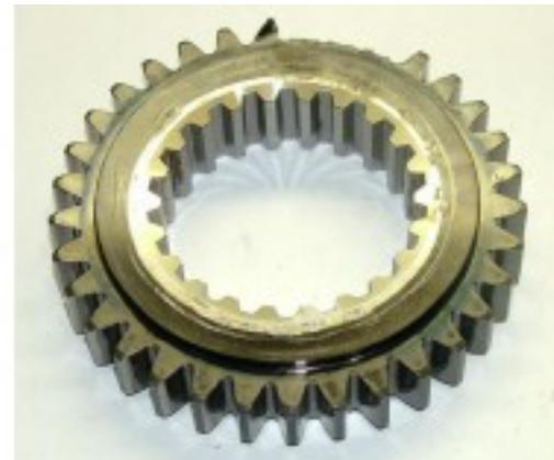
図 2 (b)SRIQ/DLC 歯車 破面全体図
