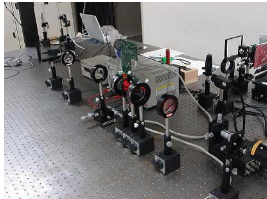
図4：PAL-SLM を用いたプログラマブル光再構成型ゲートアレイと結像方式ライターのブロック図と光学系写真
