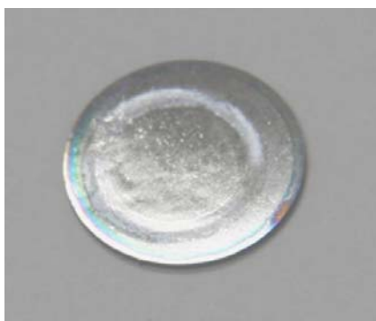
図 6 水素透過試験後の Nb-5mol%W-5mol%Mo 合金膜試料の外観写真
