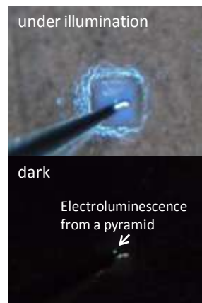
図9 GaN 六角錐の表面に成長した InGaN/GaN 多重量子井戸への電流注入時の発光。
