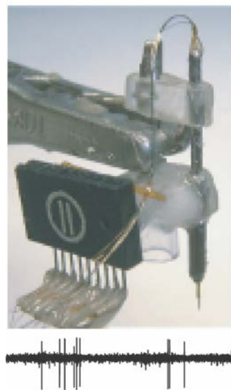
図1. 行動中のソングバード脳内から細胞外記録された神経活動と記録装置
