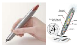
【図1 デジタルペンとその構造】
