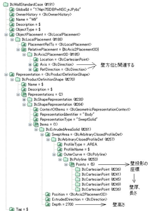
図 3 壁の方位、高さなど情報の出力
