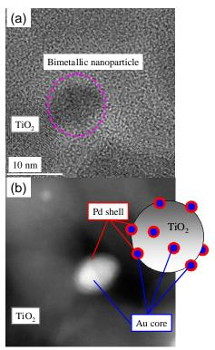
(2) 二酸化チタン表面に固定化するコア/シェル粒子の金/パラジウムの組成を系統的に変化させた試料を調製し、光触媒活性の評価を行った。結果を図2に示した。なお金とパラジウムの総モル数はいずれの試料においても一定である。パラジウムは金よりも仕事関数が大きいため、二酸化チタンへの光照射で生じた電子をより効率的に捕捉することが知られる。しかし金と合金化すると、
