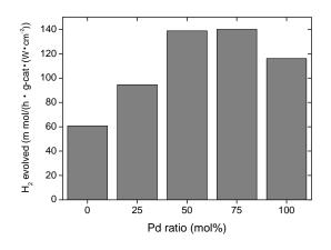
パラジウム増加に応じて、光触媒活性は単調には増加せず、合金ナノ粒子におけるパラジウム組成が 75 mol%で最大活性を示した。このような「最適値」は、金・パラジウム合金ナノ粒子を通常の触媒として使用した際にも報告されており、その組成も今回得られた値に類似(パラジウムの割合が 75-80mol%)している点は興味深い。
