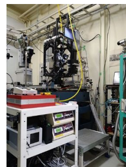
図1. レーザー照射による急速溶解・急速凝固現象のその場観察システム。
