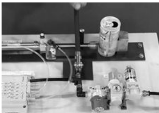
図2 エアシリンダー残圧による 飛び出し
