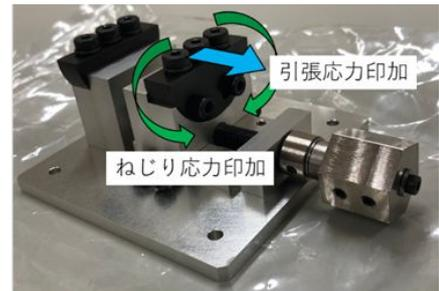
図1: 応力印加治具
