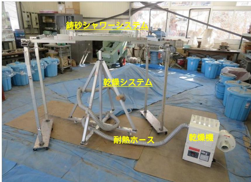
図1 鑄砂シャワーシステムと乾燥システムの構築
