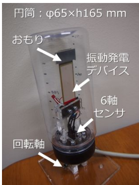
図-1 発電装置の概要
