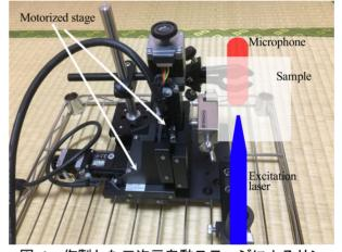
図 1.作製した二次元自動ステージによるサンプル台.
