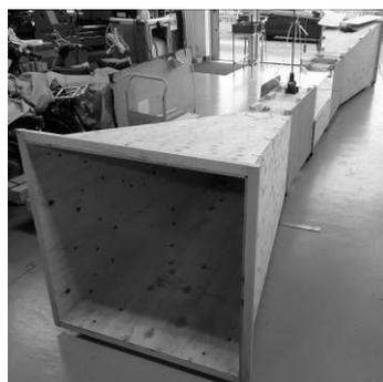
図9 製作した簡易風洞
