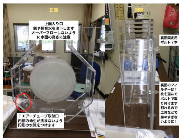
図1 培養器の2面図と各部名称
