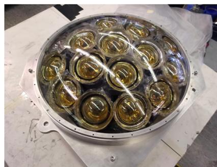
図 3 マルチ PMT の試作機
