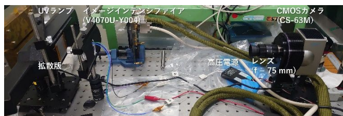
図 4. フォトンカウンティング評価試験の様子。
