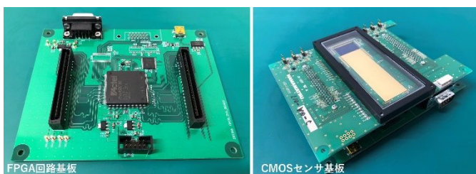
図 6. 選定した CMOS センサ (右) 及び開発した FPGA 回路基板 (左)。
