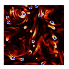
乗に比例するので、結果として乱流エネルギーが低減することが分かった。また、この物理描像に基づけば、粒子添加による乱流低減量を粒子まわりの付加的なエネルギー散逸率を用いて評価することができる。また、乱流低減が起こるための必要条件が、粒子の速度緩和時間と乱流中の最大渦の旋回時間の比(ストークス数)を用いて記述できることを示した(参考文献[2])。周期境界条件下の乱流に対しては、非球形の剛体粒子を添加した場合も、上述の物理描像が基本的には変わらないことを示した。つまり、同じ体積と質量をもつ剛体粒子であれば、アスペクト比の大きな粒子ほど乱流低減効果が大きいが、これは粒子の回転の効果ではなく、並進運動による
