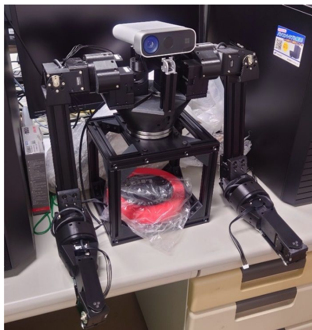
図8 東京工業大学で開発した人型ロボットの上半身
