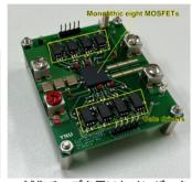
(a)試作チップ (b)QFNパッケージに実装した試作チップ (c)試作チップを用いたインバータ 図 4 8つのMOSFETで構成される集積化5レベルインバータの試作チップと回路実装
