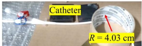
図4 提案する光ファイバセンサを組み込んだ医療用カテーテルによる曲げ計測実験[4]
