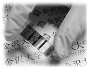
図 1 有機・無機ハイブリットペロブスカイト太陽電池の写真。ペロブスカイト膜は電子輸送層(ETL)とホール輸送層(HTL)に挟まれ、さらに、透明電極 ITO と金属電極により挟まれたサンドイッチ構造となっており、様々な異種材料で構成された太陽電池となっている。
