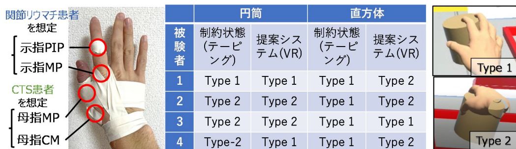
図4 テーピングによる可動域の人工的制約手と体験システムでの同様な身体性体験時の把持姿勢比較実験の結果
