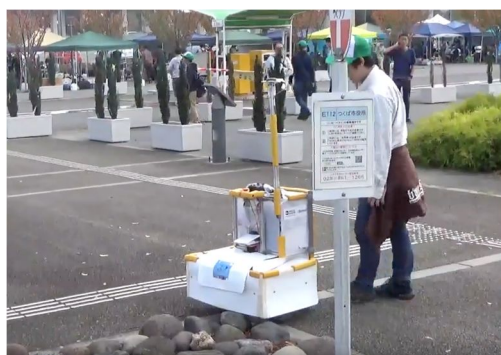
図1: ロボットが角で縁石に乗り上げリタイヤ (2018年つくばチャレンジにて)
