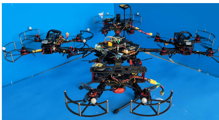
図 2: 再帰推力構造の飛行ロボット実機
