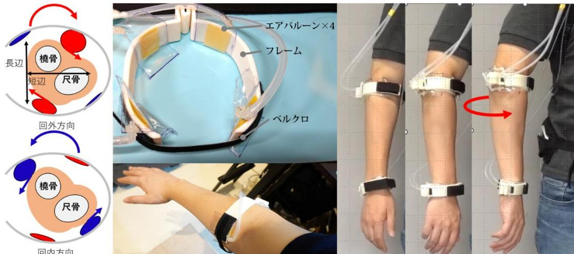
図 2：肘でのハンガー反射。(左)各方向提示に必要な圧迫及び皮膚変形方向，(中央)デバイス及び装着の様子，(右)回内方向の肘ハンガー反射
