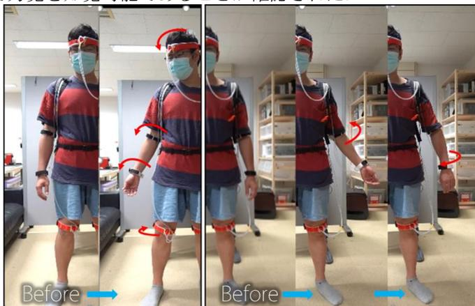
図5：複数部位へのハンガー反射同時提示の様子. (左)頭部・肘・手首・膝へのハンガー反射同時提示, (右)肘・手首への異なる方向へのハンガー反射同時提示
