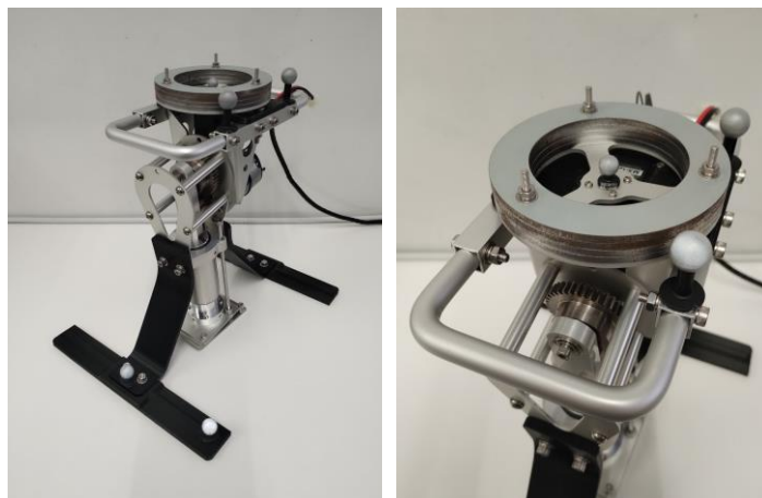
図2 リアクションホイールを搭載した小型模型ランマー（左：全体図、右：上部拡大図）
