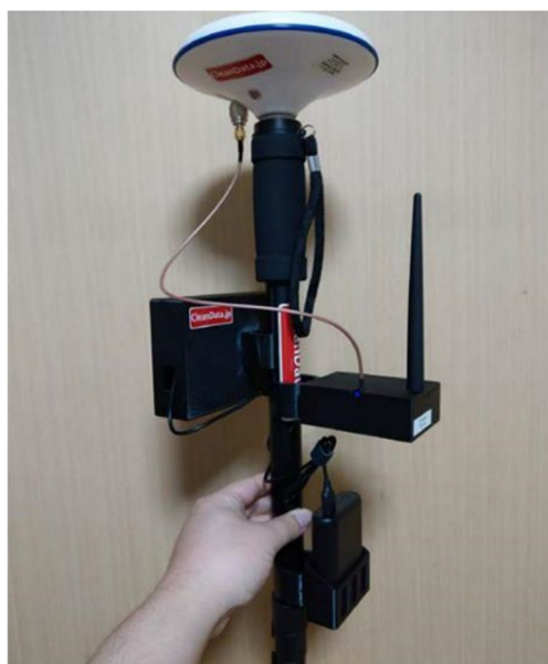
図4) 開発した GNSS 機器
