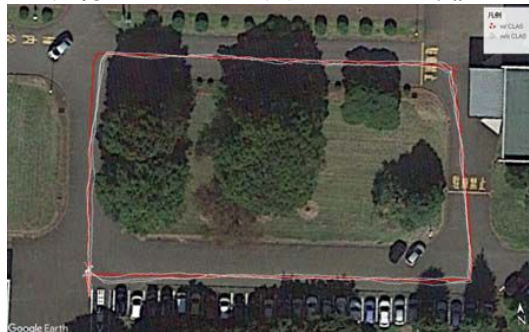
図 4 高精度人工衛星測位 CLAS による自動走行地中レーダの走行精度評価
