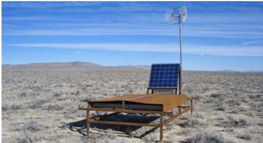
図1: TAの地表検出器のうちの1台。1.2km間隔の碁盤目に507台を置いて、700km<sup>2</sup>の地表(ほぼ琵琶湖の面積に相当)をカバーしている。
