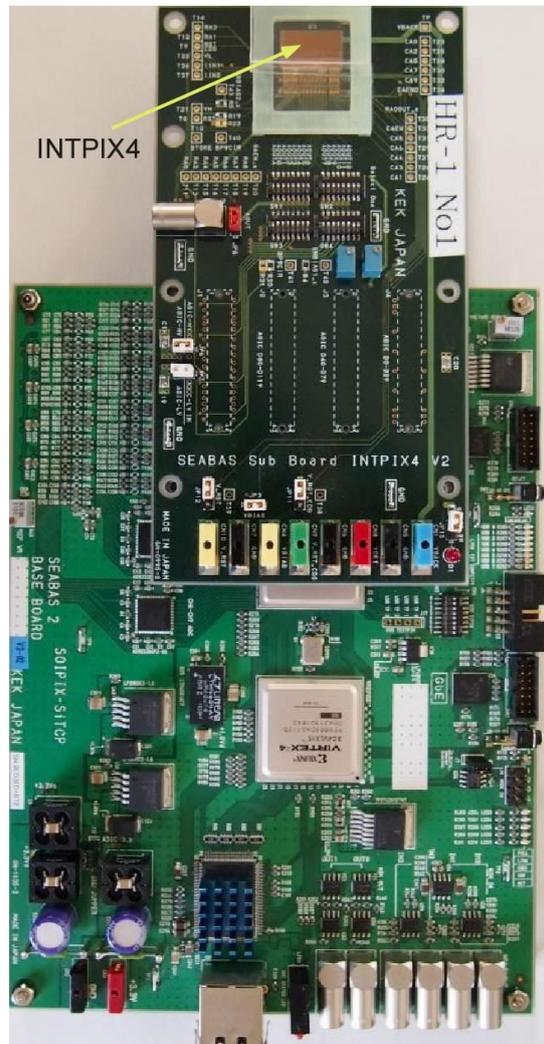
図 2. SOI 検出器 (INTPIX4) と読み出しボード (SEABAS) の写真。
