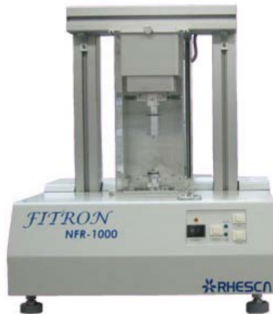
図1 試作したナノファイバー力学強度試験機：協働企業：(株)レスカから製品化された。
